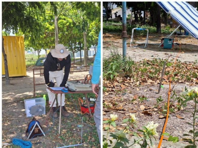
Figura 31 - Execução de Sondagem Elétrica Vertical e Caminhamento Elétrico na Praça Parque da Juventude Nascentes das Águas Claras I, Novo Aleixo
