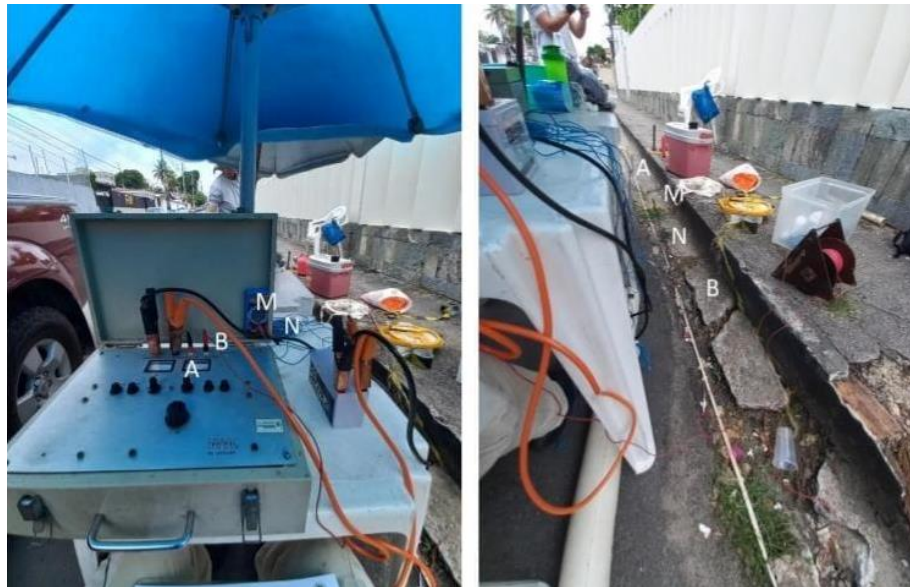
Figura 12 - Resistivímetro Tectrol e eletrodos AB e MN em arranjo Schlumberger
