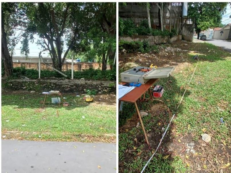
Figura 26 - Execução de Sondagem Elétrica Vertical em terreno próximo ao Clube Hípico de Manaus no bairro Nossa Senhora das Graças
