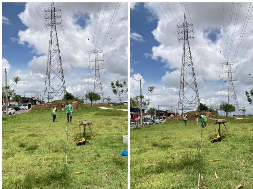
Figura 28 - Execução de Sondagem Elétrica Vertical em canteiro central na Avenida das Torres, bairro Flores
