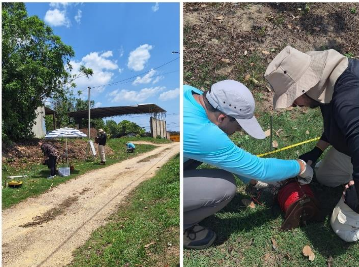
Figura 34 - Execução de Sondagem Elétrica Vertical e Caminhamento Elétrico em estrada de terra batida com acesso pela Avenida dos Guaranás próximo ao Aterro Sanitário de Manaus, bairro Lago Azul
