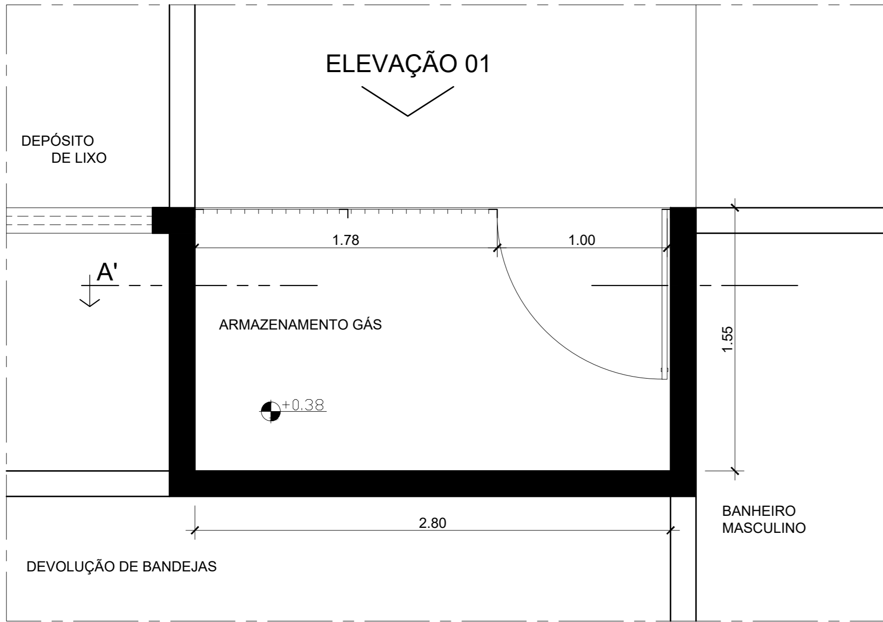
PLANTA - ARMAZENAMENTO DE GÁS Escala: 1/30
