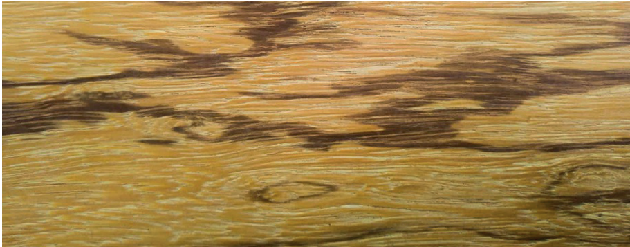
FIGURA 4 Aspecto visual da face tangencial da madeira Angelim-rajado. Fonte: Autores, 2020.
