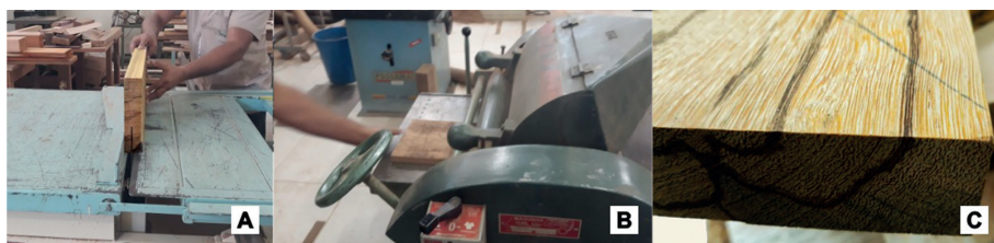
FIGURA 3 Processos de corte na serra circular (A), desengrossadeira (B) e peça gerada (C). Fonte: Autores, 2020.
