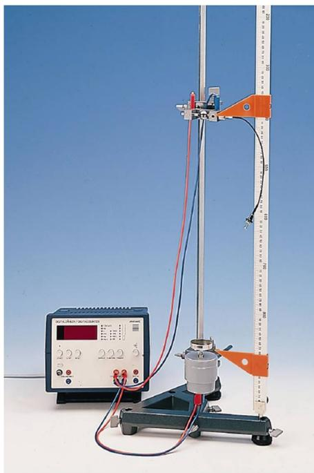
Figura 3.1: Montagem para queda livre.
