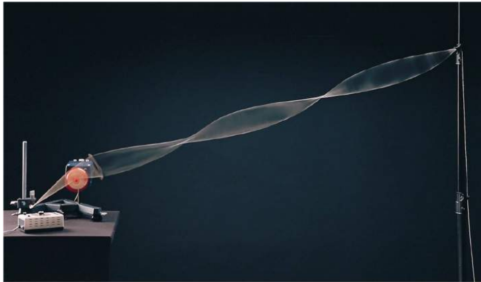
Figura 3.1: Montagem do experimento sobre oscilações forçadas.
