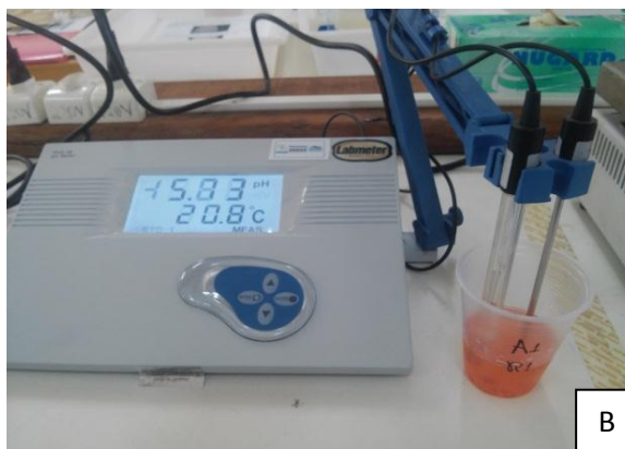
Figura 8. Calibração do pHmetro/solução tampão (A) e leitura do pH (B) de frutos de morango ( Fragaria ananassa Duch.)
