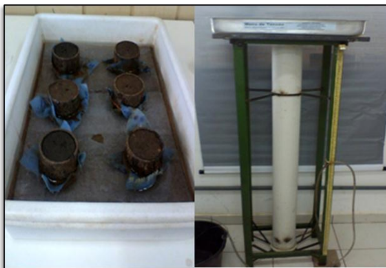
Figura 3: Saturação das amostras por elevação gradual de um lamina d'água e mesa de tensão.
