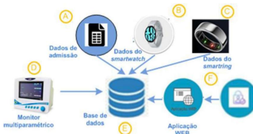
Figura 1: Ilustração das etapas a serem utilizadas para o desenvolvimento de uma ferramenta para aquisição e armazenamento da base de dados sincronizada com informações de readmissão hospitalar e dados do paciente coletados através de smartwatch, smartring e monitor multiparamétrico.
